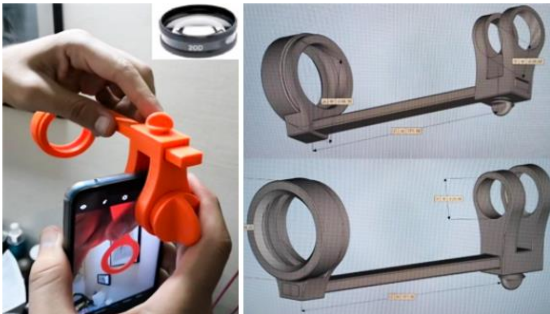
Fig. 2- Aditamento para tomar imágenes de fondo de ojo acoplado a teléfono inteligente y usando lupa de 20 dioptrías Volk.
