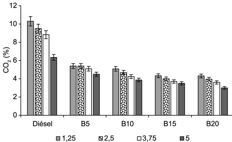
Figura 10. Emisiones de CO<sub>2</sub> a 1 800 rpm y con variación en la carga del motor.
