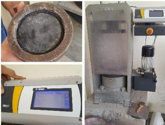
Figura 40. Máquina para pruebas de compresión.
