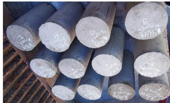
Figura 14. Probetas de hormigón desmoldadas
