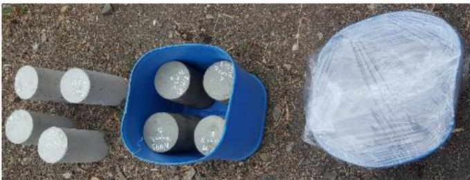
Figura 23. Probetas de hormigón al quinto día tras fundición.
