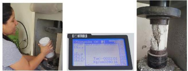
Figura 50. Rotura de probeta #11.
