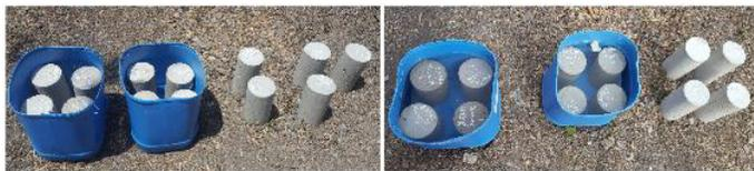
Figura 16. Probetas de hormigón previo a curado.
