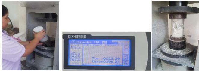
Figura 46. Rotura de probeta #6.
