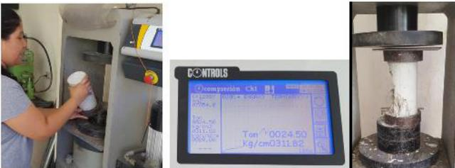
Figura 48. Rotura de probeta #3.
