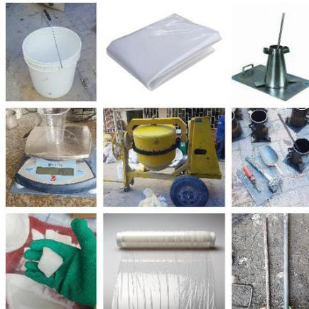
Figura 2. Herramientas para probetas y segmentos de losa.
