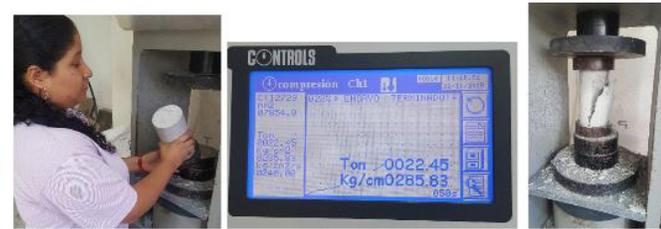
Figura 47. Rotura de probeta #10.
