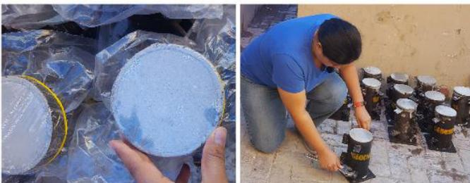
Figura 13. Desmolde de probetas
