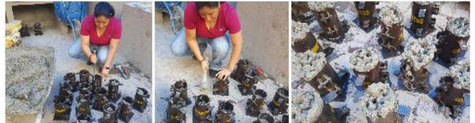
Figura 9. Relleno de probetas de hierro fundido.
