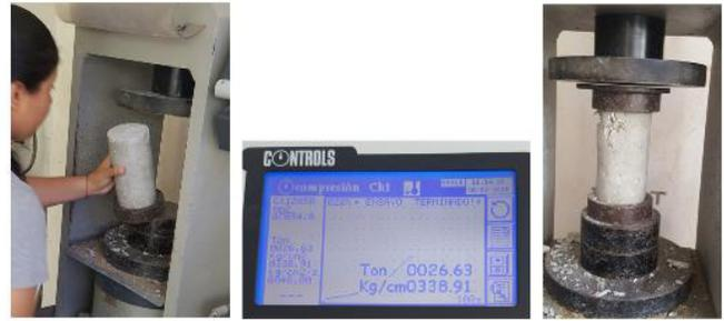
Figura 49. Rotura de probeta #7.
