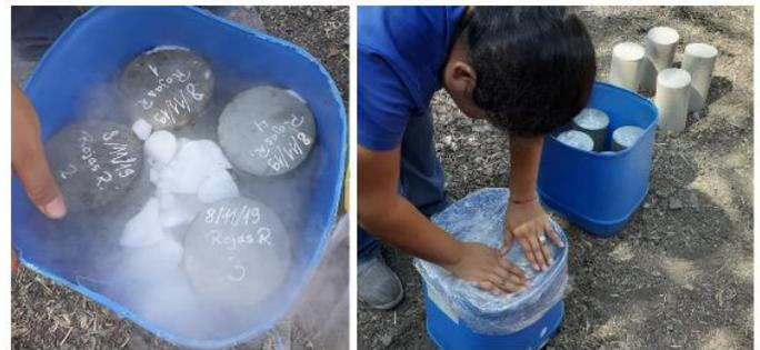
Figura 18. Probetas de hormigón al primer día tras fundición - día.
