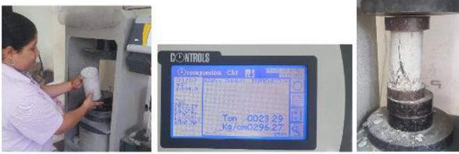
Figura 45. Rotura de probeta #2.
