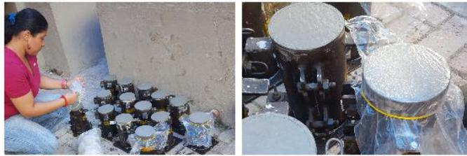
Figura 12. Curado inicial de probetas.
