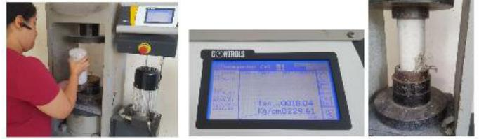
Figura 41. Rotura de Probeta #1.
