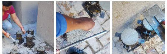
Figura 10. Acabado de probetas.
