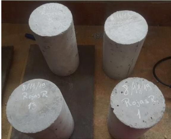
Figura 39. Probetas de hormigón en laboratorio para prueba tras siete días.
