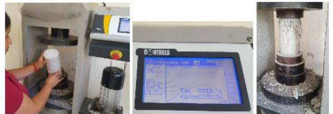
Figura 43. Rotura de probeta #9.
