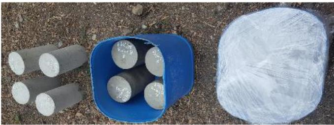
Figura 22. Probetas de hormigón al cuarto día tras fundición.
