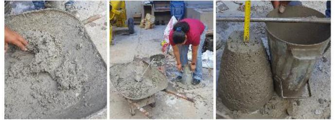
Figura 8. Ensayo de cono de Abrams.
