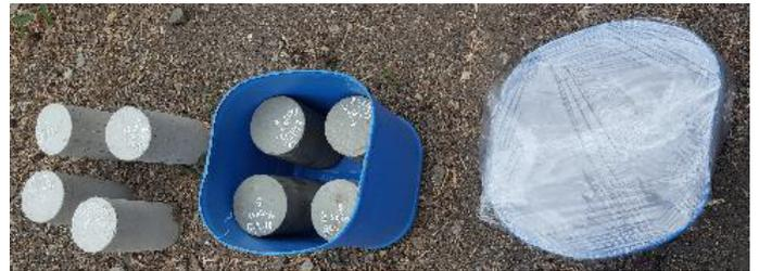
Figura 25. Probetas de hormigón al séptimo día tras fundición.
