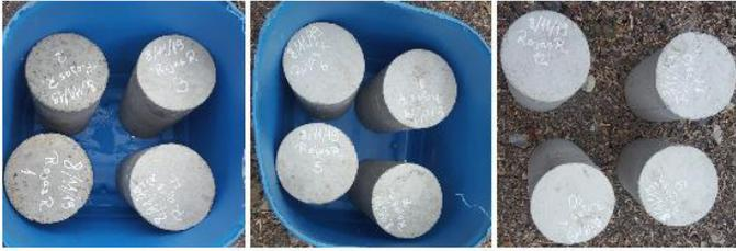
Figura 20. Probetas de hormigón al segundo día tras fundición.
