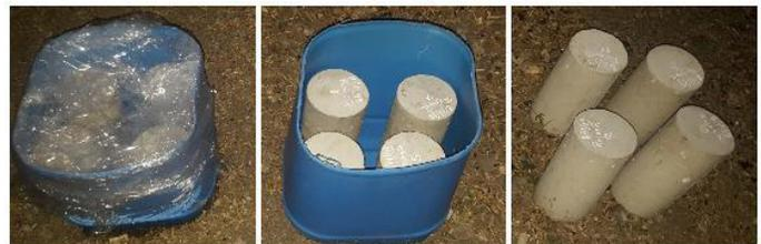
Figura 19. Probetas de hormigón al primer día tras fundición - noche.
