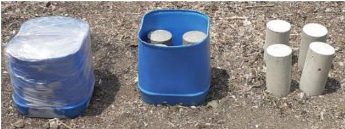
Figura 21. Probetas de hormigón al tercer día tras fundición.
