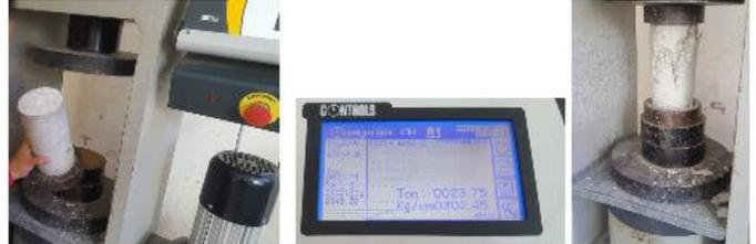
Figura 42. Rotura de probeta #5.
