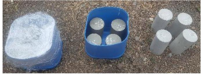
Figura 24. Probetas de hormigón al sexto día tras fundición.
