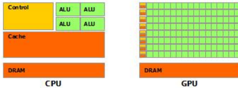
Figura 2. Distribución de las unidades de procesamiento en la CPU y GPU
