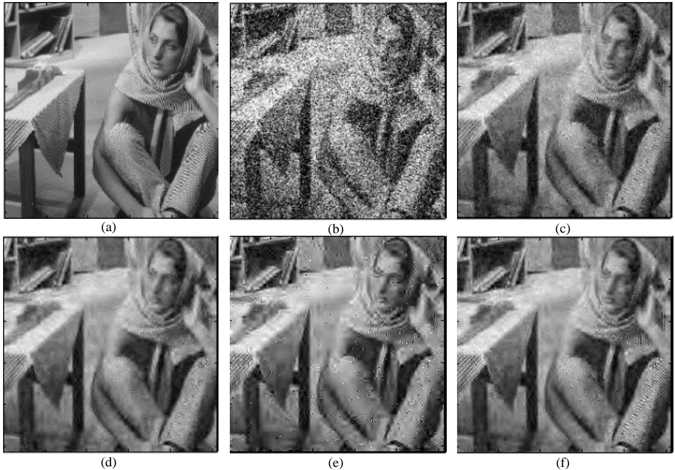
Figura 5. (a) Imagen “Bárbara” libre de ruido. (b) La misma imagen alterada con ruido de \sigma_n = 70 . (c) Resultado de Neigh Shrink, PSNR = 21,30 dB. (d) Resultado de BiShrink, PSNR = 22,57 dB (e) Resultado de Neigh Preserve, PSNR = 20,99. (f) Resultado del método propuesto PSNR = 22,82
