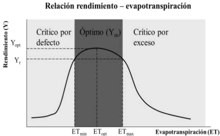
Figura 1. Relación entre la evaporación y el rendimiento de un cultivo. Representa los puntos críticos por defecto o exceso de la aplicación de agua y la ventana de aplicación óptima.
