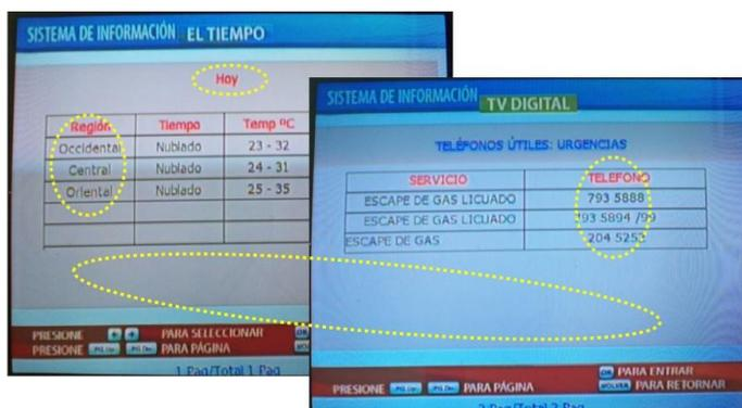
Figura 3. Pantallas de TV donde se observa el servicio de datos actual en la sección Tiempo (izquierda) y la subsección Urgencias (derecha). Los problemas se señalan encerrados en discontinuas.
