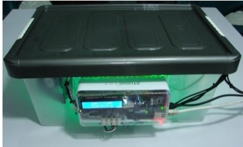
Fig. 4 - Maqueta de un proceso térmico a escala para las experimentaciones.
