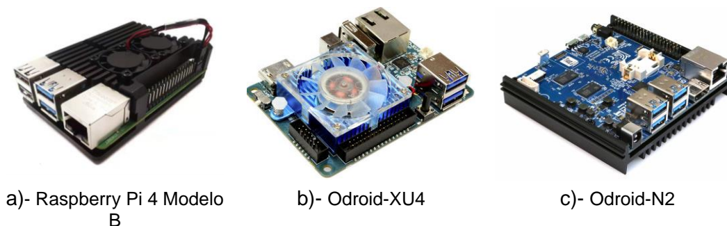
Fig. 5 – Ordenadores de placa reducida empleados para la representación de las señales de radar.
