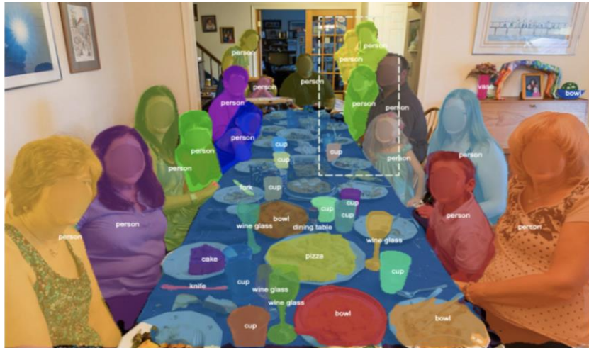
Fig. 8 - Ejemplo de segmentación visual de Detecron2: los objetos de cualquier tamaño están bien delineados y los objetos superpuestos se procesan correctamente.
