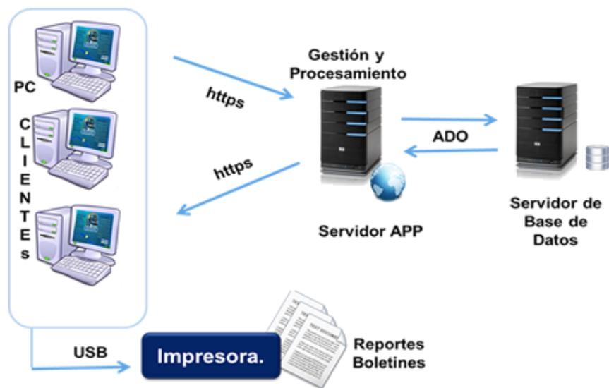
Figura 2. Diagrama de Modelo de Despliegue.
