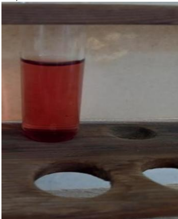
Fig. 7. Identificación de Zinc con ferrocianuro de potasio K_4[Fe(CN)_6] en medio básico.
