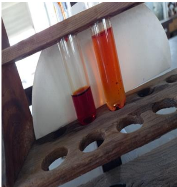
Fig. 8. Identificación de Zinc con Ditzona al 10% en medio básico.
