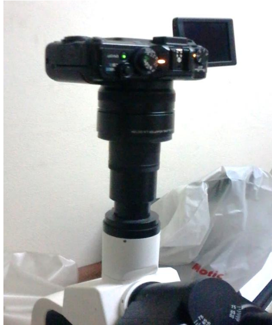
Fig. 3 - Cámara acoplada de forma fija al microscopio.
