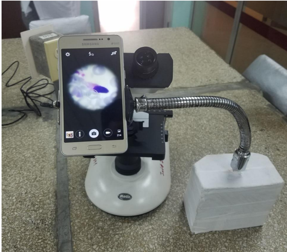
Fig. 2 - Dispositivo que permite el acople de un teléfono móvil a un microscopio convencional.
