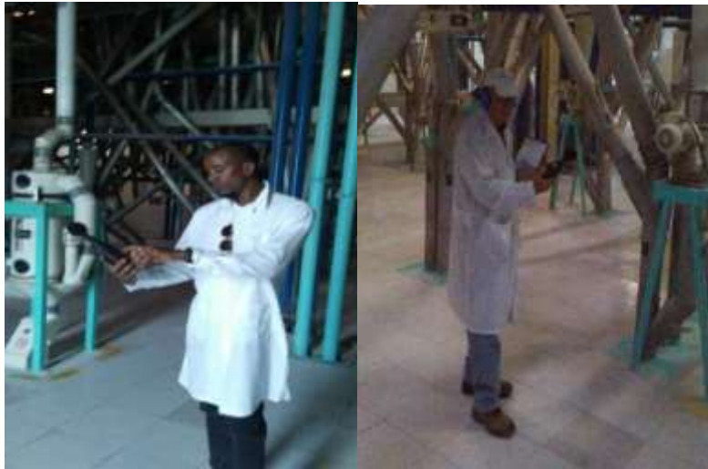
Fig. 2. Posición de sonómetro y del observador respecto a una fuente de ruido.
