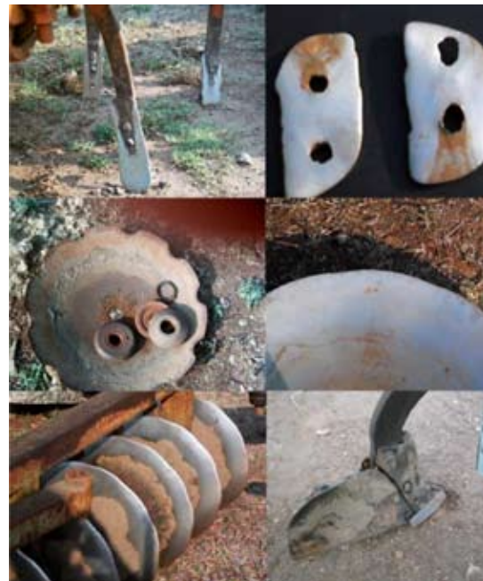
FIGURA 4. Desgaste de los órganos de trabajo de los aperos de labranza.
