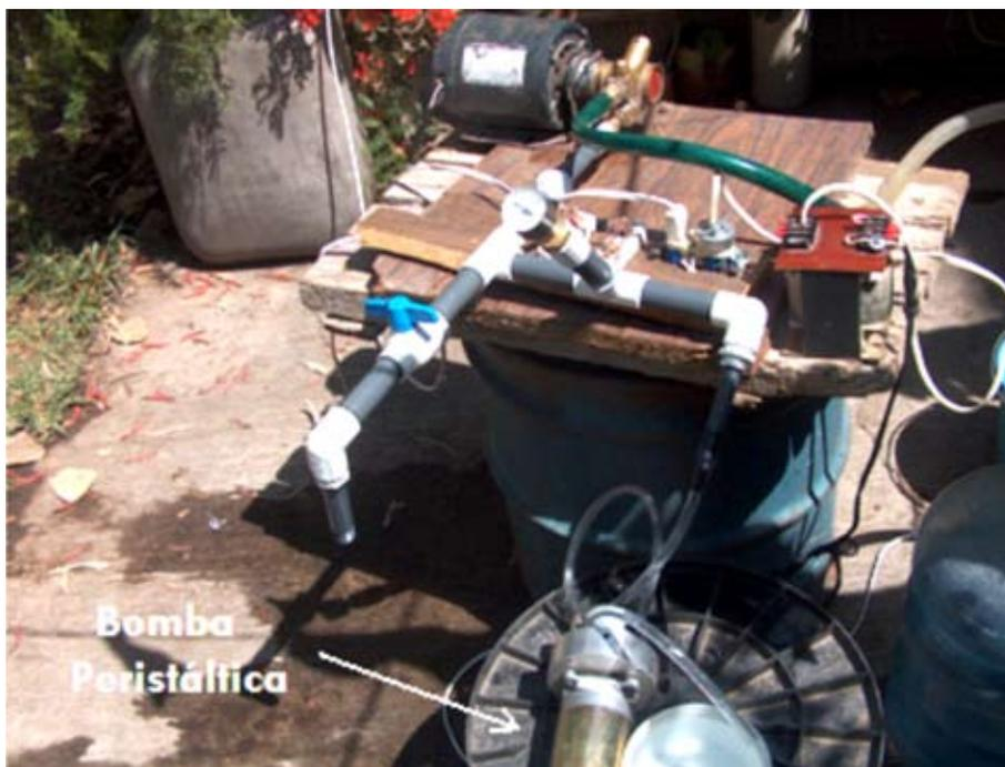
FIGURA 8. Sistema para suministrar y controlar la presión del agua en la tubería de la bomba peristáltica.
