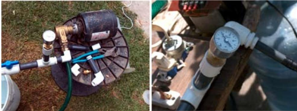
FIGURA 6. Instalación para la prueba de la bomba de paletas rotatorias.
