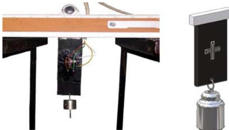
FIGURA 3. Muestra fijada rígidamente en uno de sus extremos.
