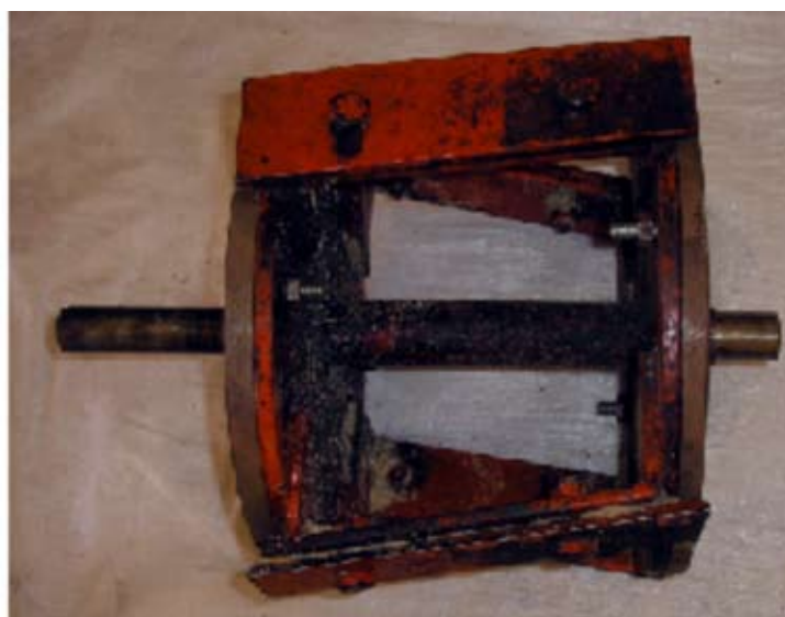
FIGURA 4. Platos laterales atornillados al tambor.
