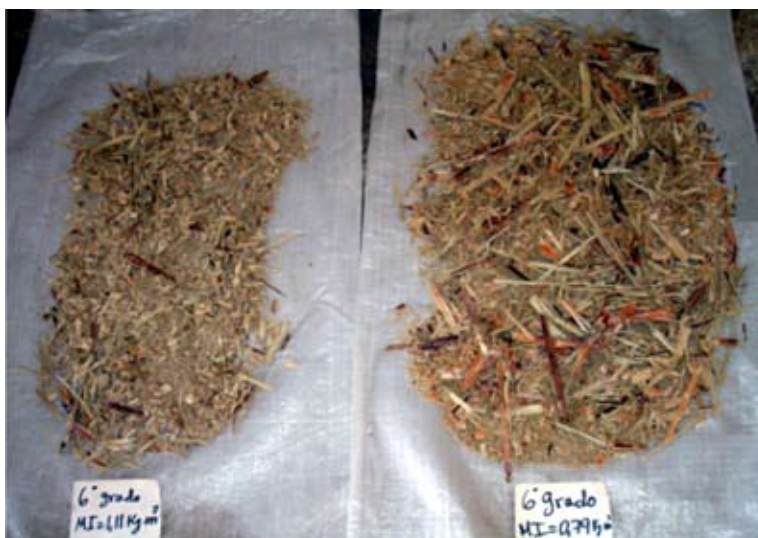
FIGURA 11. Comparación del grado de desmenuzamiento de los tallos de caña con I_r=0,791 \text{ kg}\cdot\text{m}^2 y I_r=1,117 \text{ kg}\cdot\text{m}^2 .
