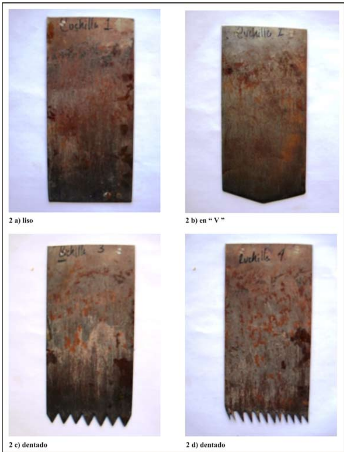
FIGURA 2. Formas del borde cortante de las cuchillas.
