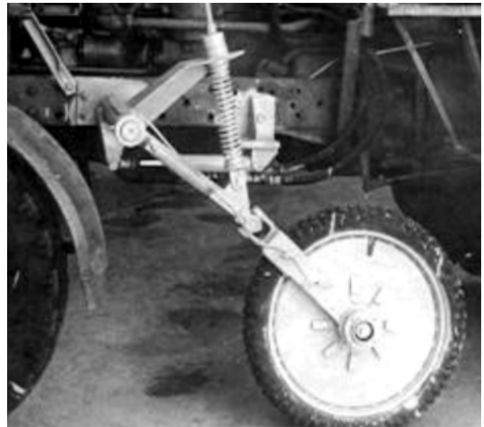
FIGURA 6. Esquema de la quinta rueda.
