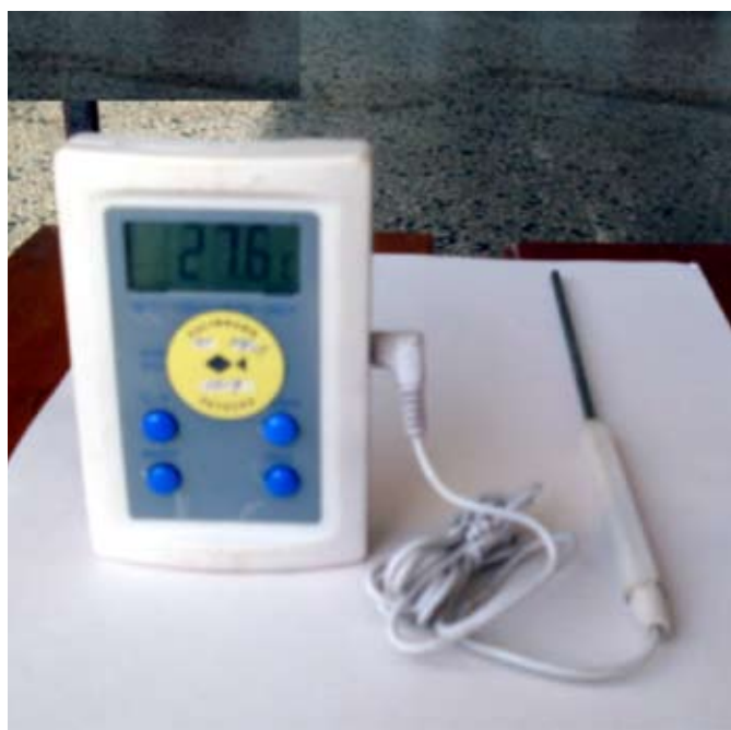
FIGURA 3. Termómetro digital para medir la temperatura ambiente.
