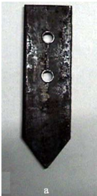
FIGURA 7. Reja empleada en el experimento de desgaste.
