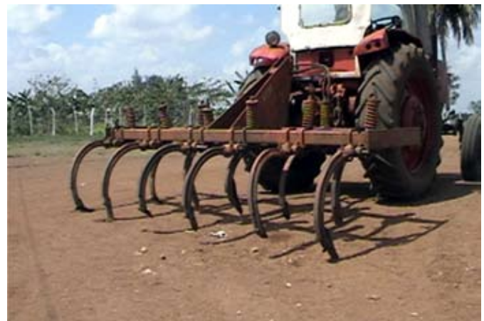
FIGURA 2. Agregado empleado en los experimentos de desgaste.
