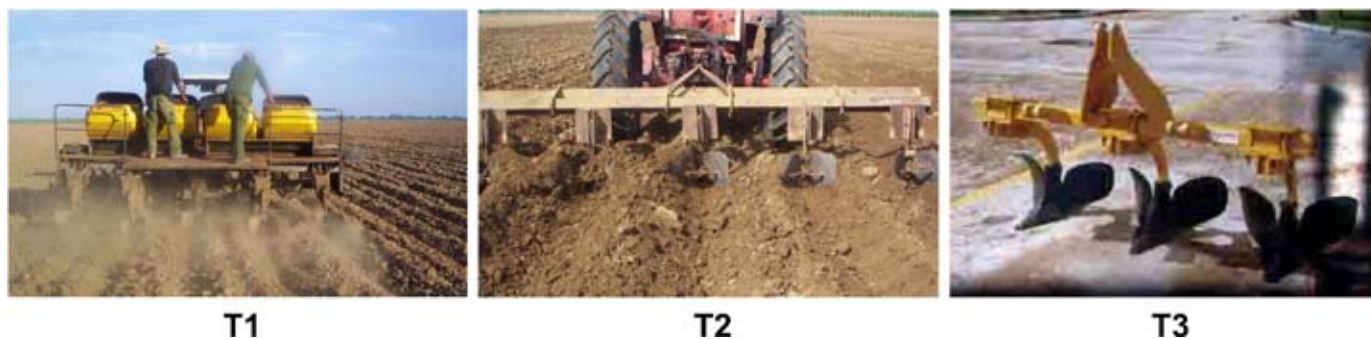
FIGURA 1. Tratamientos evaluados en la labor de surcado: T1- Tractor MTZ-50 y Surcador Fertilizador IIMA-BALDAN 4 500; T2- Tractor MTZ-50 y Surcador Aporcador SA-5; T3- Tractor MTZ-50 y Surcador Aporcador SA-3 (NC 3463:88; NC 3449: 03; NRAG XXI y XX2: 2005).
