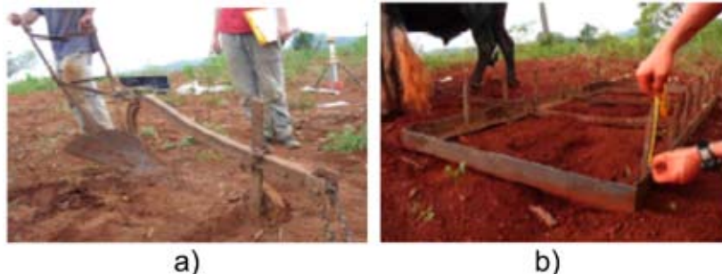
FIGURA 1. a) Arado de vertedera o americano utilizado y b) Grada de púas utilizada.
