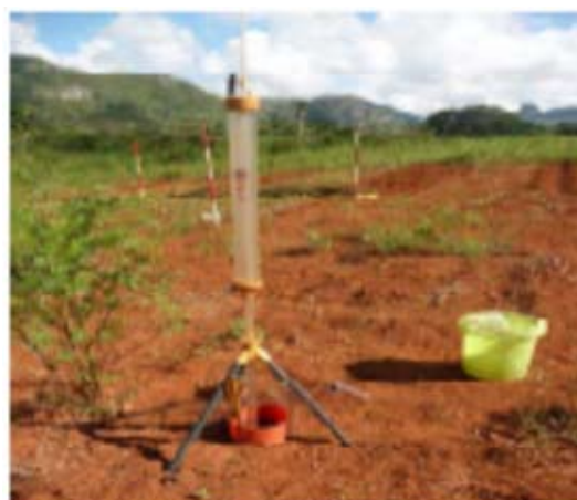
FIGURA 2. Permeámetro de Guelph con un solo anillo.
