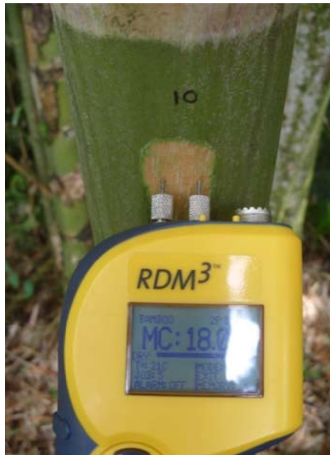
FIGURA 13. Medida obtenida por higrómetro comercial en Guadua N.10. Se muestra perforación y adecuación para toma de medidas.
