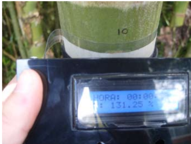
FIGURA 12. Medida obtenida por prototipo en Guadua N.10. No se realizan ningún tipo de perforaciones a la planta.
