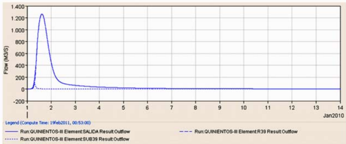
FIGURA 9. Hidrograma en la salida de la cuenca del río Coro para 500 años de período de retorno sin considerar la falla de la presa del embalse “El Isiro”
