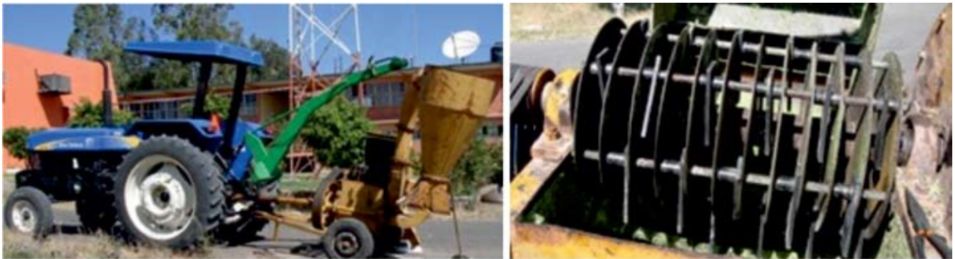
(a) (b) FIGURA 1. Molino de martillos; (a) vista general del equipo; (b) tambor rotativo.
