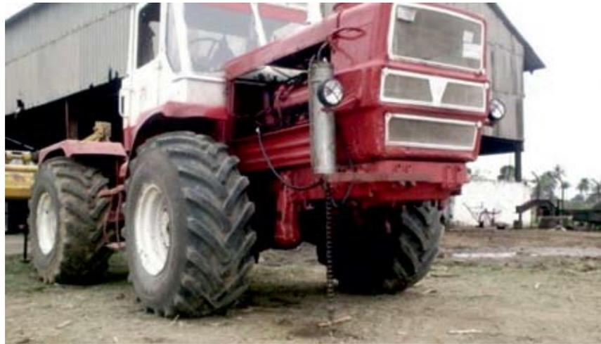
FIGURA 1. Depósito aforado para determinar consumo de combustible.
