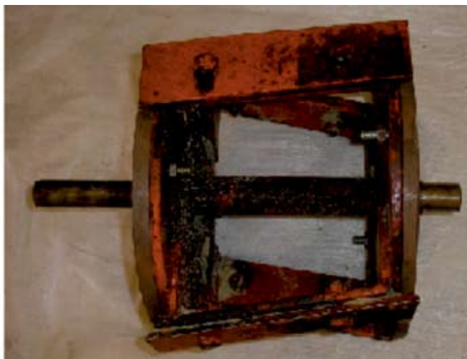
FIGURA 4. Platos laterales atornillados al tambor.
