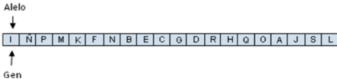
FIGURA 2. Representación de un cromosoma para un problema tipo flow shop de 20 trabajos.
