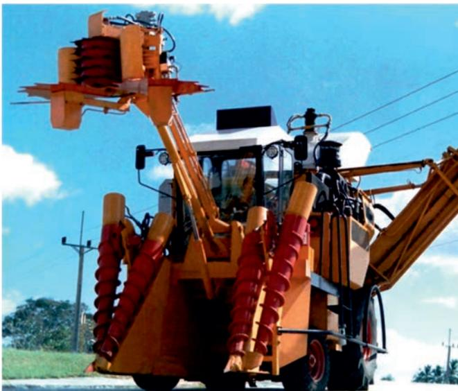
FIGURA 1. Cosechadora cubana de caña de azúcar CCA-5000 con cortacogollo desfibrador.
