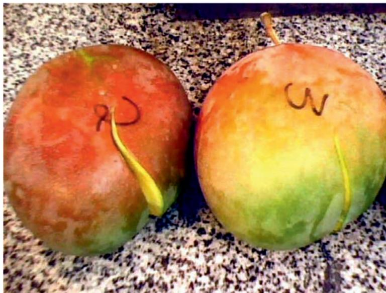
FIGURA 6. Rotura de los mangos con carga uniaxial en el ensayo de compresión.
