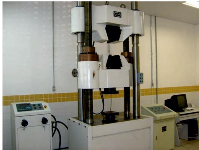
FIGURA 1. Vista del equipamiento utilizado en el ensayo de compresión.
