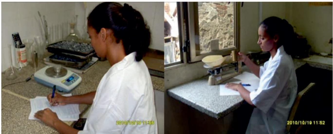
FIGURA 2. Determinación de las condiciones del suelo. a) Humedad del suelo; b) Densidad Volumétrica del suelo.
