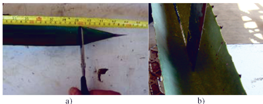
FIGURA 7. Preparación de las hojas de agave. a) Corte del excedente de la punta de la hoja. b) División longitudinal de la hoja.
