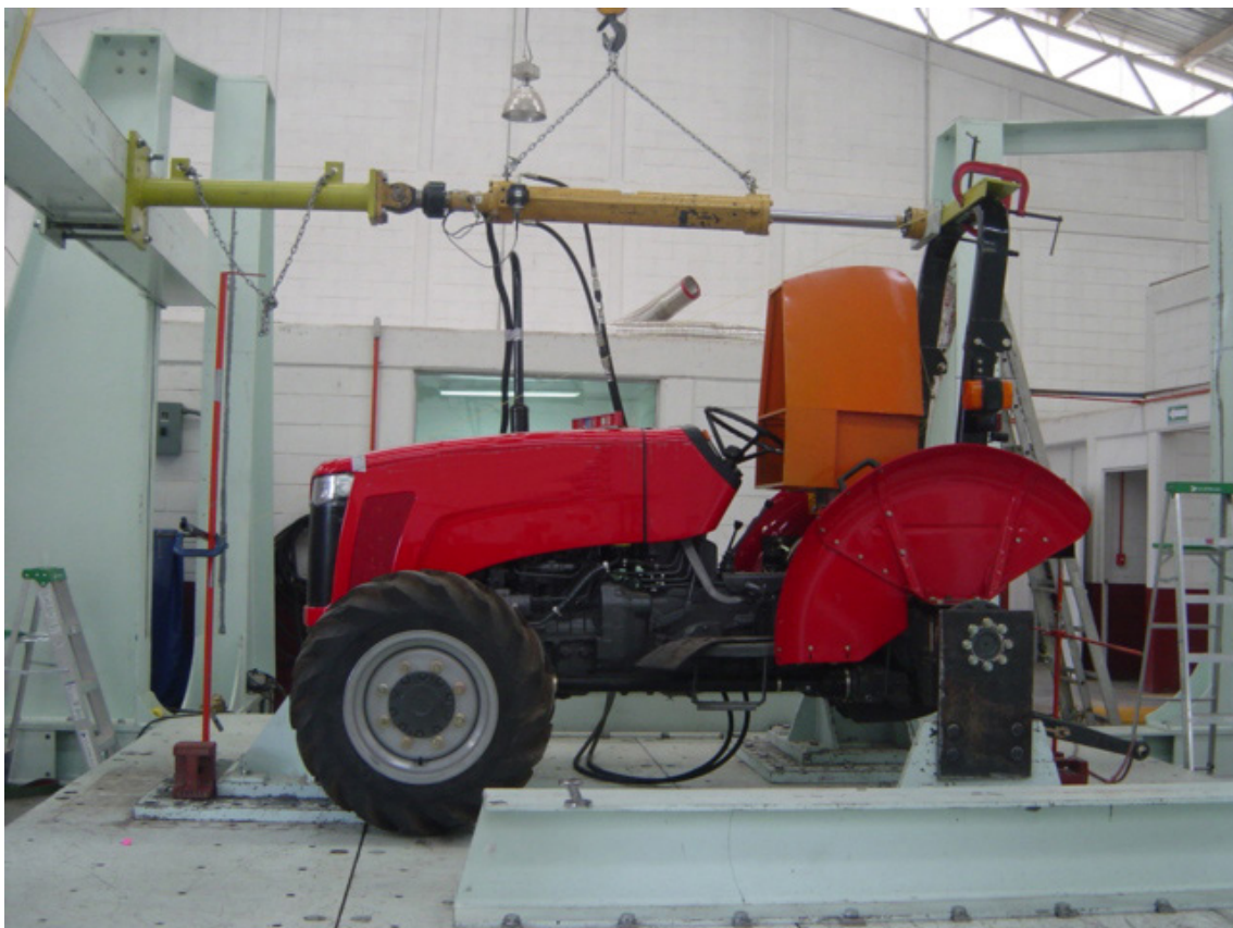
FIGURA 5. Aplicación de la carga longitudinal delantera.
