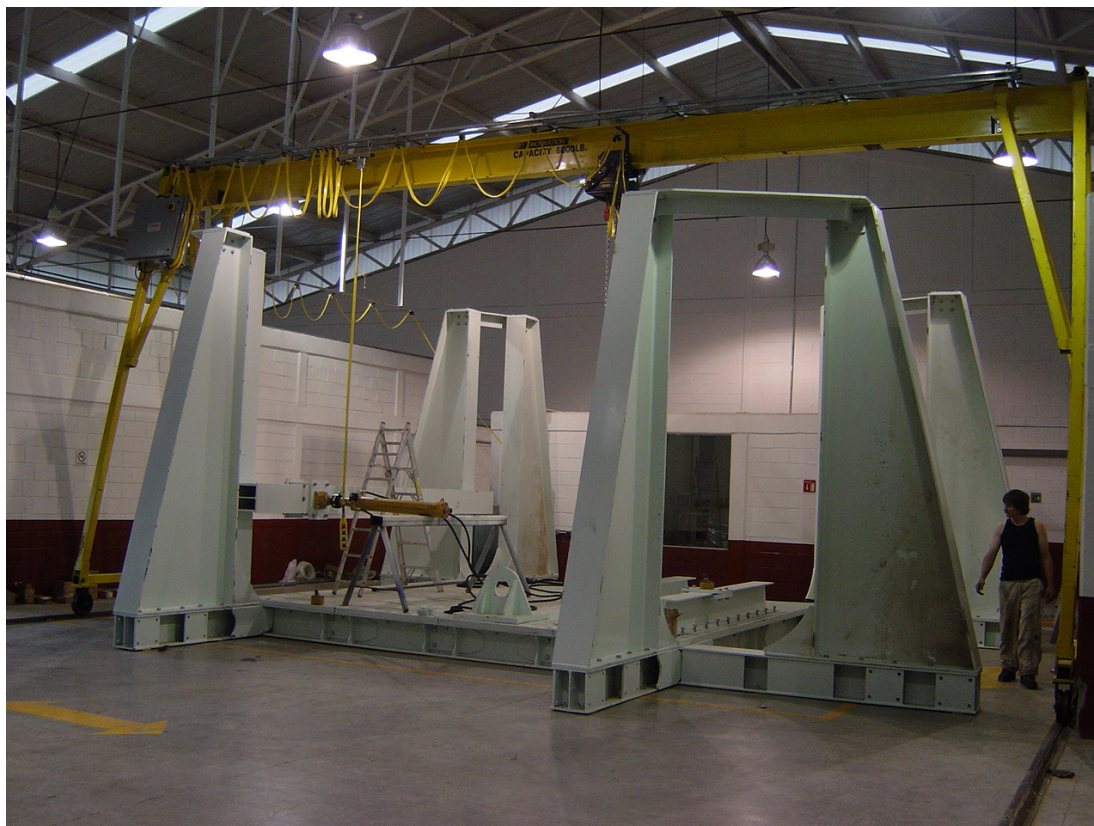
FIGURA 1. Banco de Pruebas de Estructuras de Protección CENEMA.
