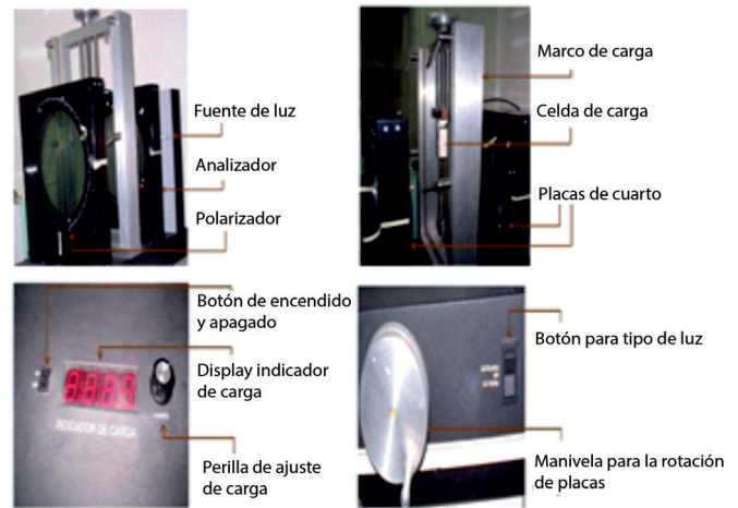
FIGURA 2. Componentes del polariscopio modelo SSM-AJ.
