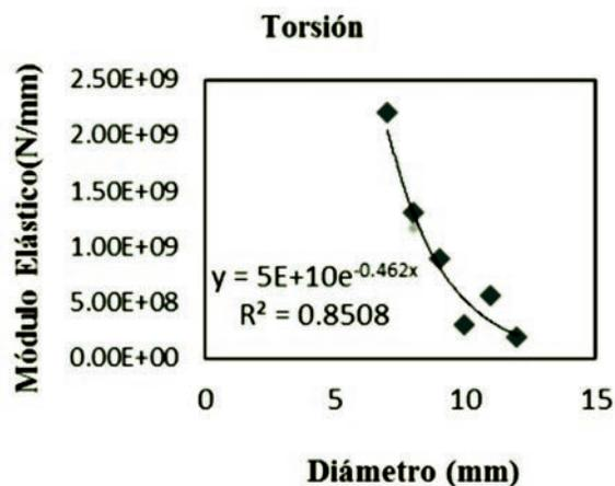
FIGURA 4. Módulo de torsión elástico en una carga de 400 g con diámetros de la rama.
