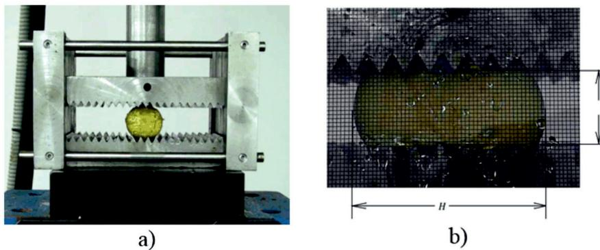
FIGURA 2. Prueba de compresión de los tallos de caña. a). Aditamento ranurado; b). Medición de la deformación lateral.
