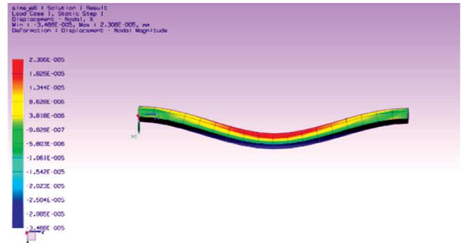
FIGURA 11. Eje 2 deformado; desplazamiento en el eje X.
