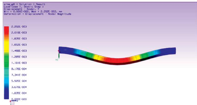
FIGURA 12. Eje 2 deformado; Desplazamiento en el eje Y.
