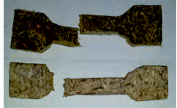
FIGURA 4. Probetas para análisis de tracción según norma (ASTM E).
