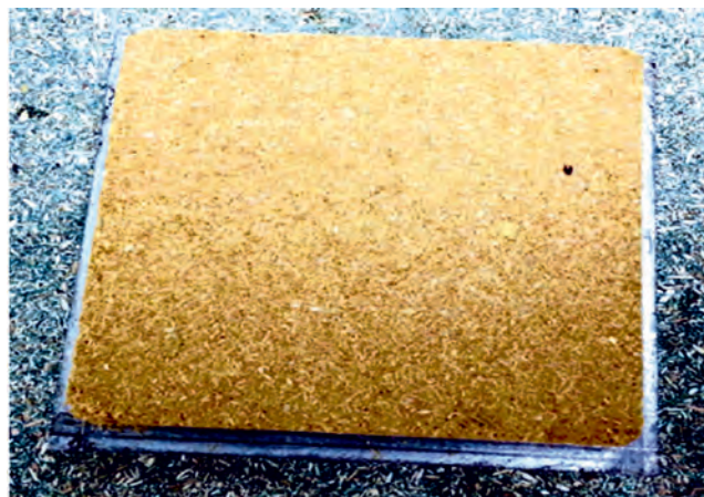
FIGURA 1. Plato de aglomerado fabricado por moldeo por planchas térmicas.
