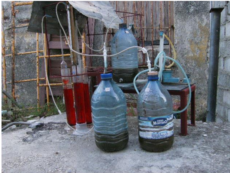
FIGURA 1. Biodigestor (Modelo reducido) y micro manómetro utilizado.
