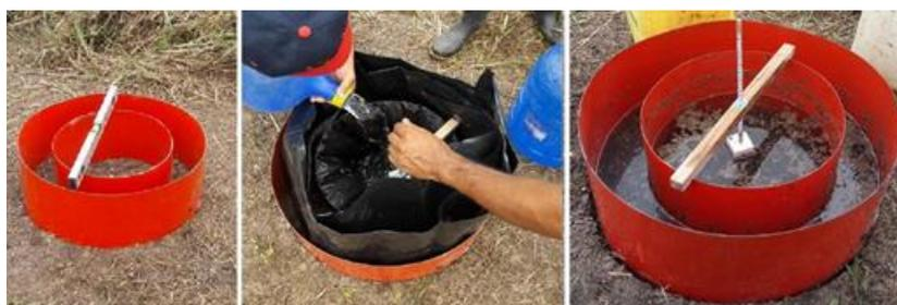
FIGURA 3. Colocación de los Anillos de Infiltración para la determinación de Velocidad de Infiltración en uno de los puntos de observación.
