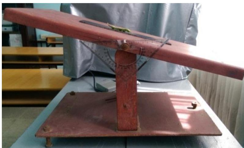
**FIGURA 5.** Determinación del ángulo de fricción para vainas en el plano inclinado.
