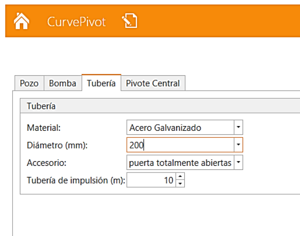
FIGURA 5. Pantalla de datos de la tubería impulsión.
