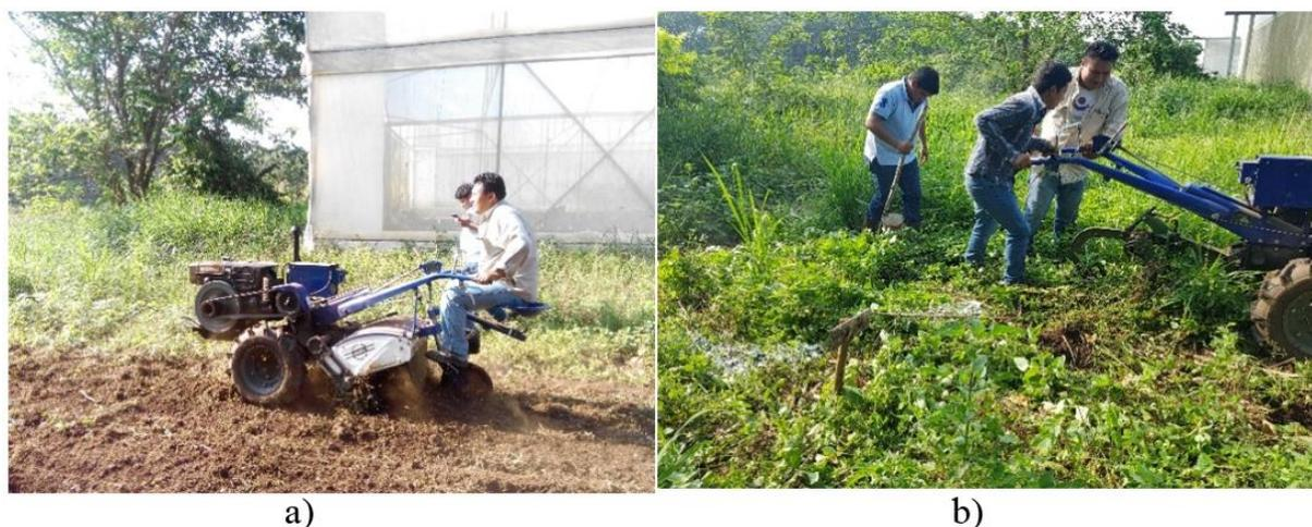
**FIGURA 2.** Implementos utilizados en la prueba a) cultivador y b) arado.
