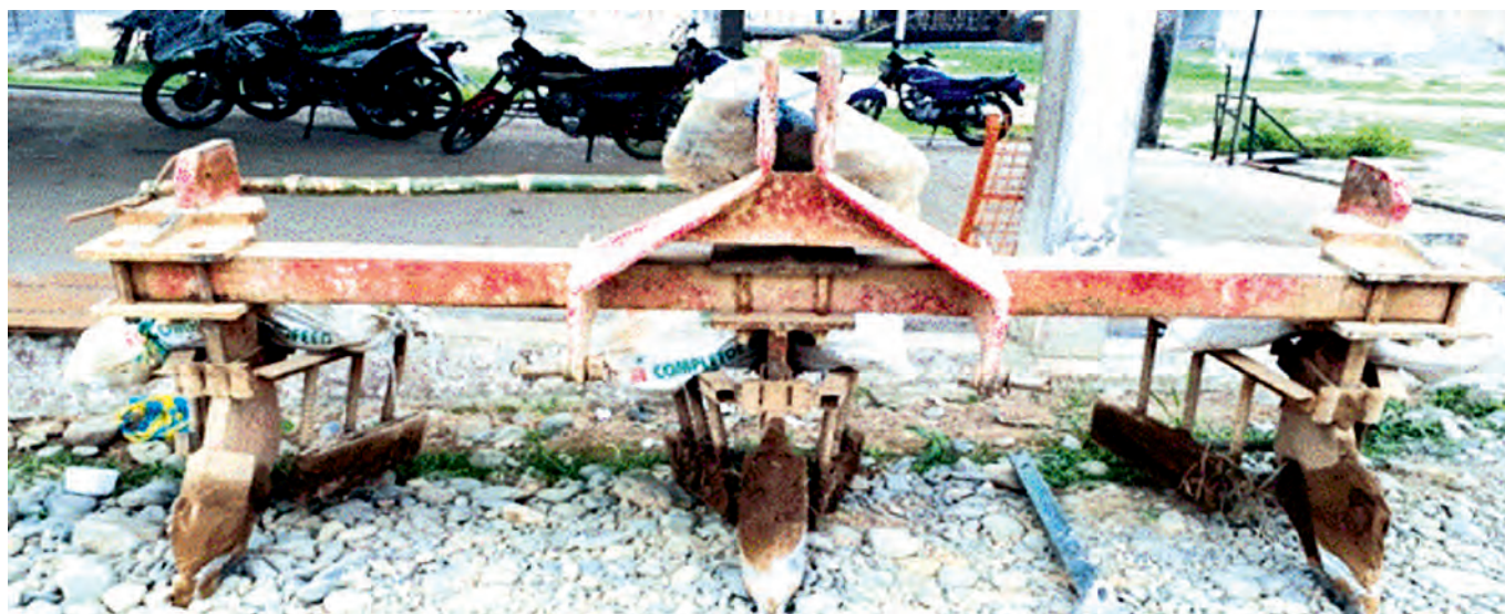
FIGURE 2. Three-body cultivator subsoiler of national manufacture. Source: Ramos (2018). FIGURA 2. Subsolador cultivador de fabricación nacional de tres cuerpos. Fuente: Ramos (2018).
