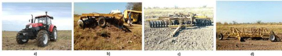
**FIGURA 1.** Tractor utilizado para formar agregado con las gradas y el alisador. a) Tractor YTO x1204. b) Grada Baldan mediana de 40 discos. c) Grada Baldan pesada de 52 discos y d) Alisador de fabricación nacional.
