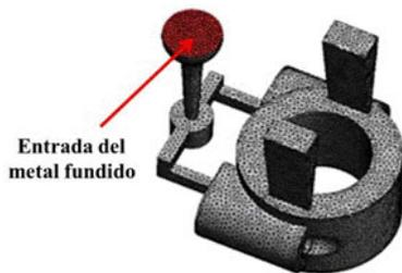
**FIGURA 7.** Modelo de análisis mallado.
