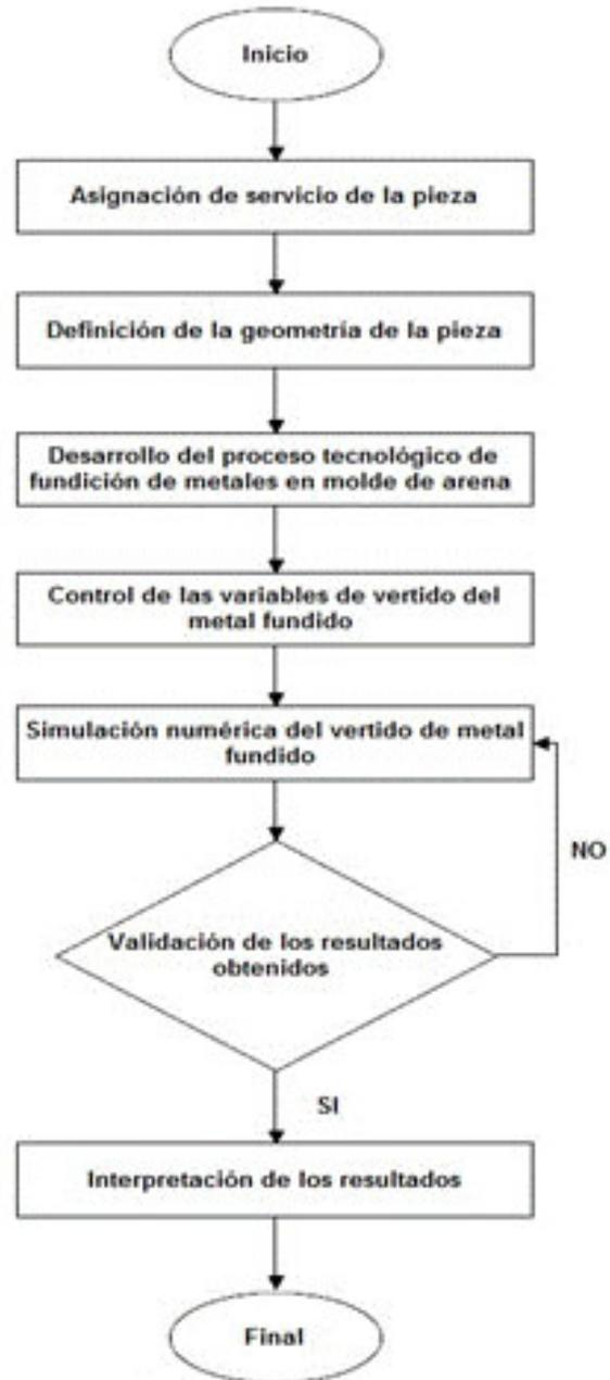
FIGURA 1. Esquema del procedimiento empleado en el análisis del vertido de metal fundido.
