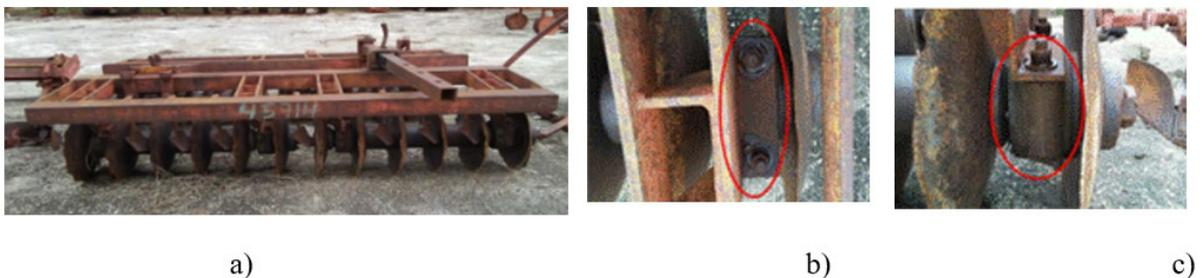
FIGURA 2. Ubicación del cuerpo del soporte de los rodamientos en la grada 4 500 lb; a) Conjunto de los elementos de la grada, b) Vista superior y c) Vista lateral.
