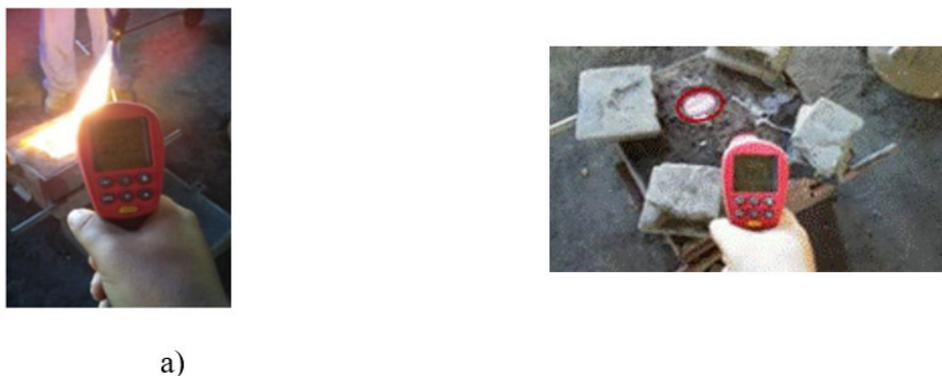
**FIGURA 5.** Mediciones de la temperatura en el molde; a) Medición de la temperatura durante el secado y precalentamiento del molde y b) Medición de la temperatura de enfriamiento de la pieza dentro del molde.
