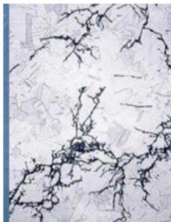
FIGURA 10. Corrosión bajo tensión.
