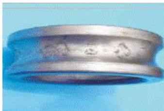
FIGURA 4. Corrosión por picadura.
