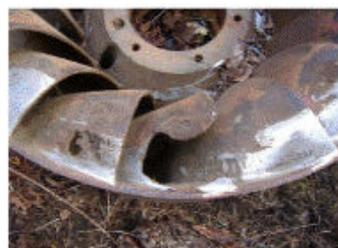
FIGURA 9. Daño por cavitación.
