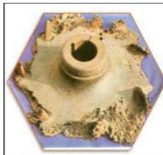
FIGURA 3. Corrosión galvánica.
