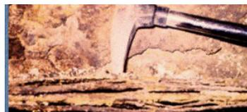
FIGURA 6. Exfoliación en planta de tratamiento de aguas.
