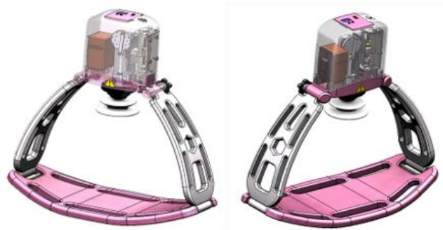
Fig. 2 Modelación 3D RCP LázarO con posibilidad de observación de componentes internos y cuerpo
