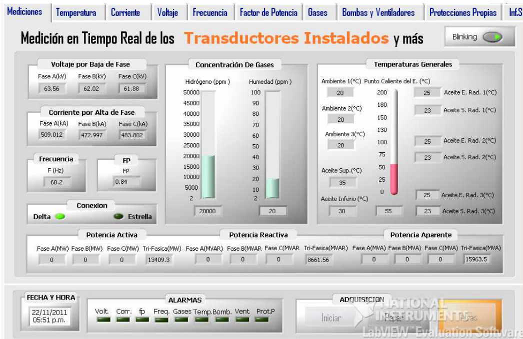
Fig. 14. Ventana visualizando las principales mediciones en el AT.
