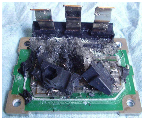
Fig. 5. Daño en un IGBT generado por la falla de una GIS de 230 kV.
